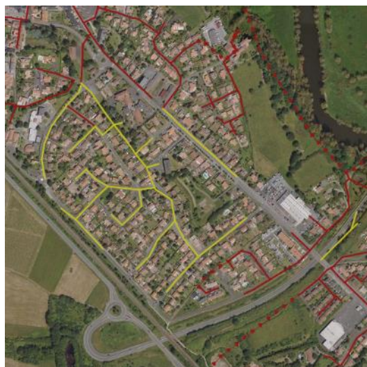
Quartier des fleurs à Gorges en réseau unitaire (tracé vert) - Projet de mise en place de deux réseaux séparés : un réseau en eaux usées d'un côté et un réseau d'eaux pluviales de l'autre.
